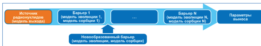
Рисунок 2.11 – Схема формирования интегральной модели прохождения поллютанта сквозь каскад эволюционирующих барьеров безопасности
