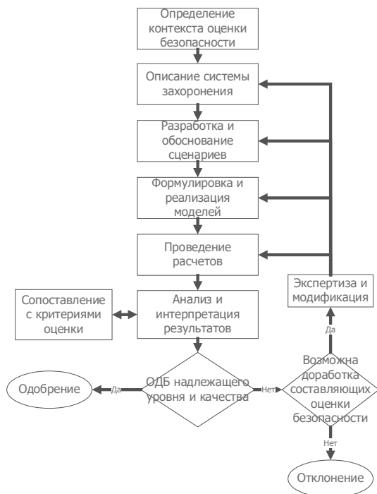
Рисунок 2.1 – Схема процесса обоснования долговременной безопасности
