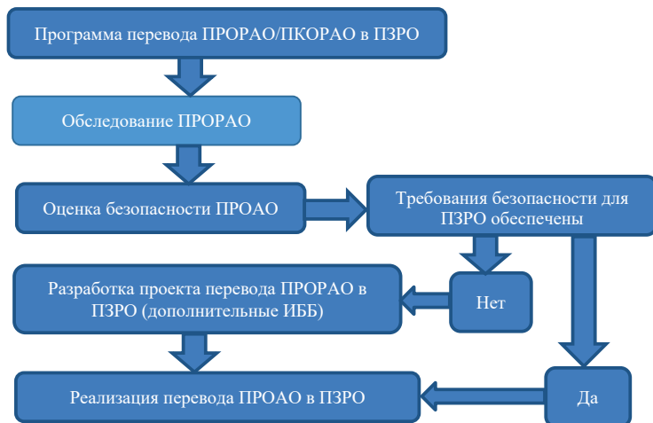
Рисунок 2.14 – Принципиальная схема основных этапов работ по переводу ПРОРАО в ПЗРО
